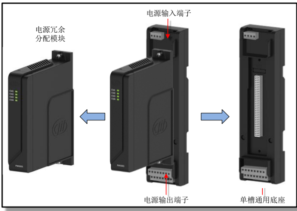
图 6-2 电源冗余分配模块单元示意图
