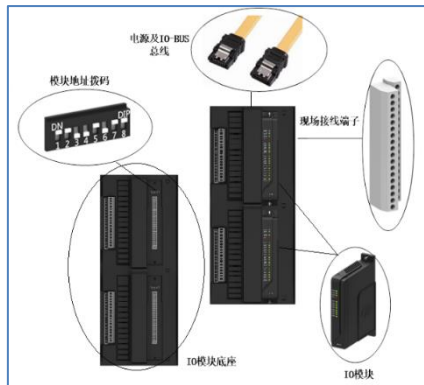
图 4-72 DI6411模块单元结构图
