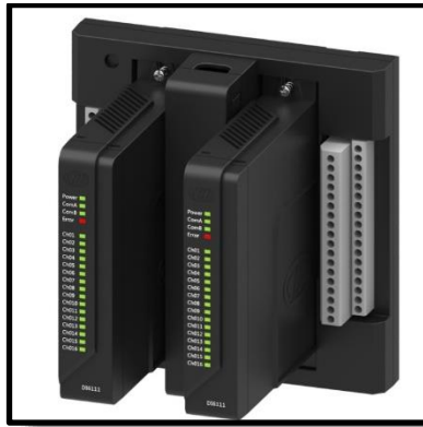
图 4-1 I/O 模块单元组装图
