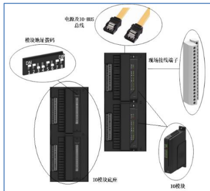
图 4-82 COM6100/6200模块单元结构示意图
